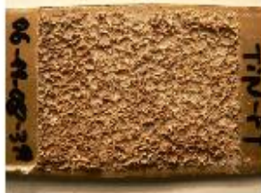
Obr. 7 Elektrody po experimentu tvorby úsad mléka
