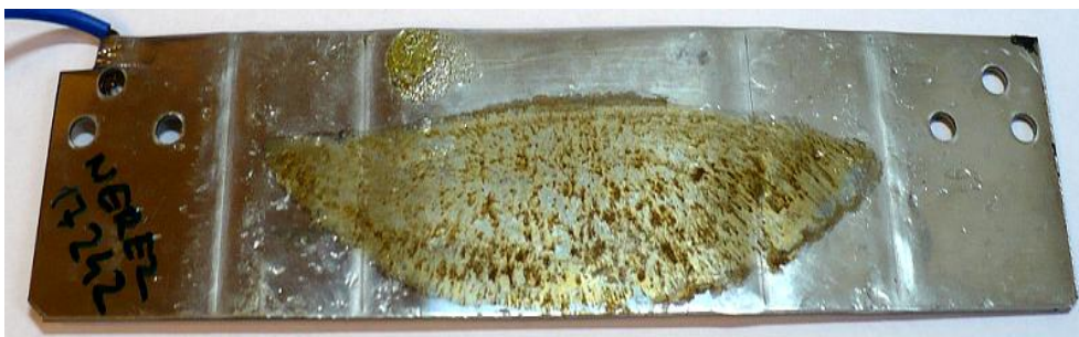
Obr. 8 Elektroda po ohřevu kousku uzeniny (nerez)
