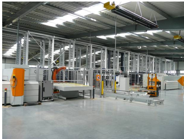
Obr. 10. Prostor vykládání a paletizace v pracovní zóně ohýbacího centra
