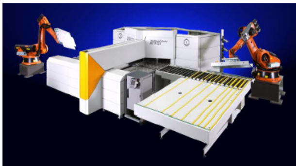
Obr. 7. Ohýbací centrum RAS Multibend 79.22-2 s manipulačními roboty KUKA
