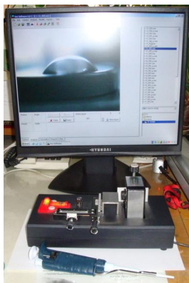
Obr.2 Kompletní SEE systém
