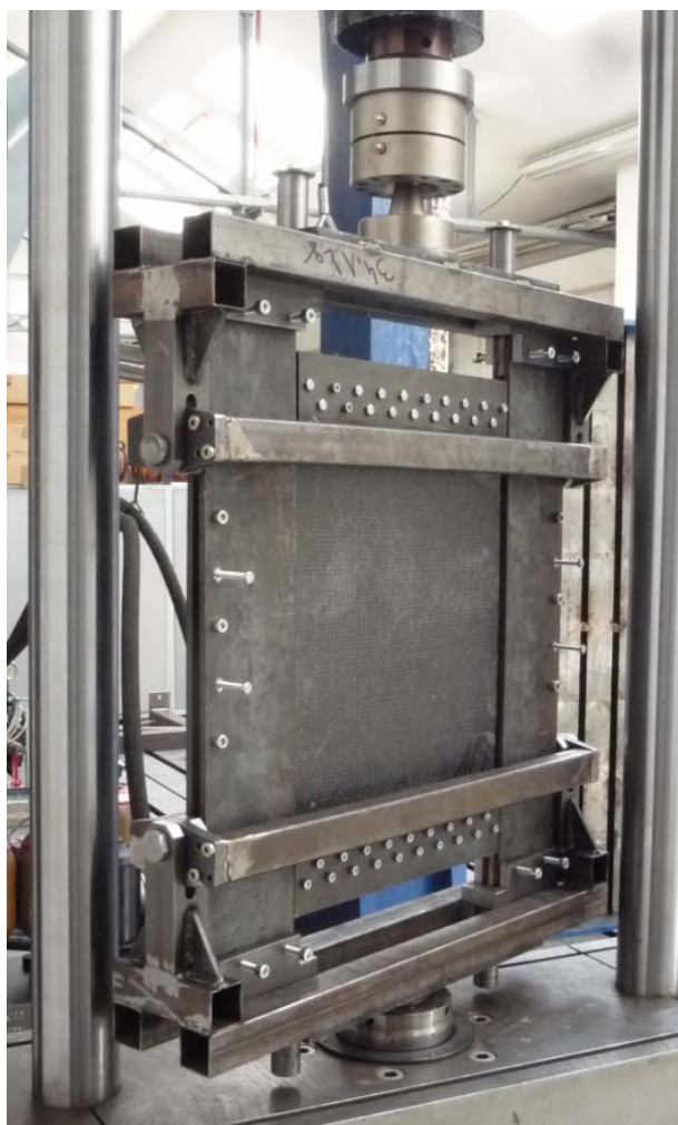
Obr. 6 - Přípravek v zatěžovacím stroji
