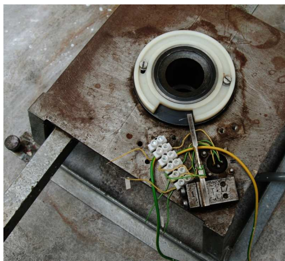
Obr. 5. Tenzometr, silonový kroužek přenášející M_k z otočného stolu na tenzometr
