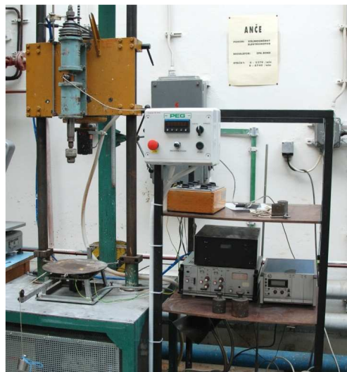
Obr. 4. Míchací stanice s otočným stolem pro měření příkonu
