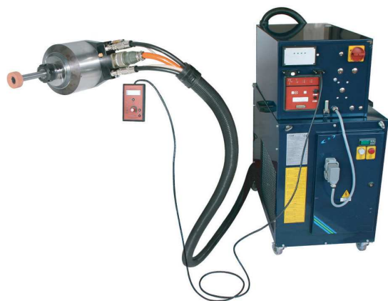
Obr. 3: Přídatné elektrovřeteno s příslušenstvím
