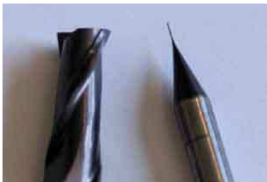
Obr. 2: srovnání 6mm nástroje a nástroje o průměru 0,2 mm, vpravo geometrie nástroje
