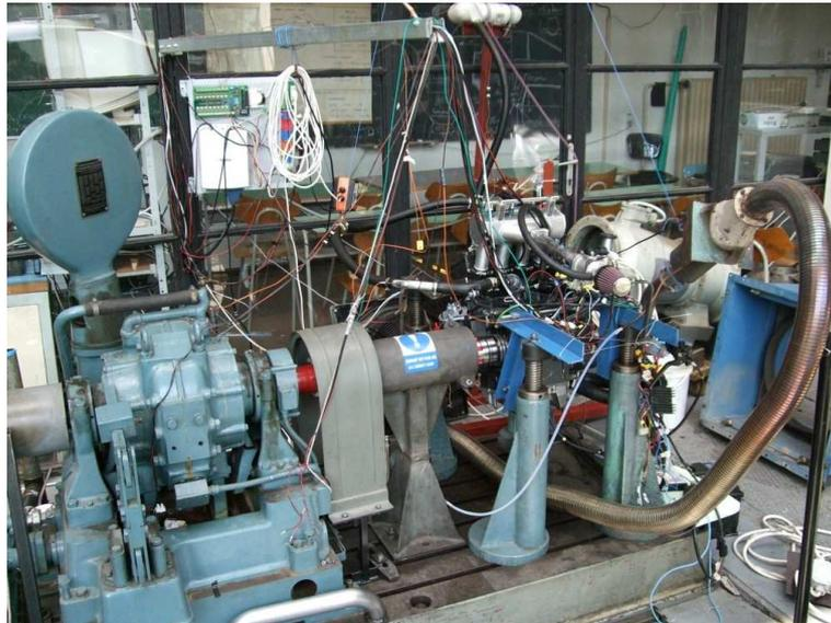
**Bild 1.** Das steuerte Maschinenaggregat. Verbrennungsmotor (rechts), Wirbelströmbremse (links).
