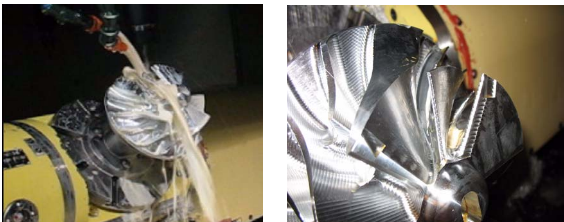
Obr. 9. Obrábění zkušební dílu; vlevo – dokončování hlavní lopatky; vpravo – detail obrobené lopatky
