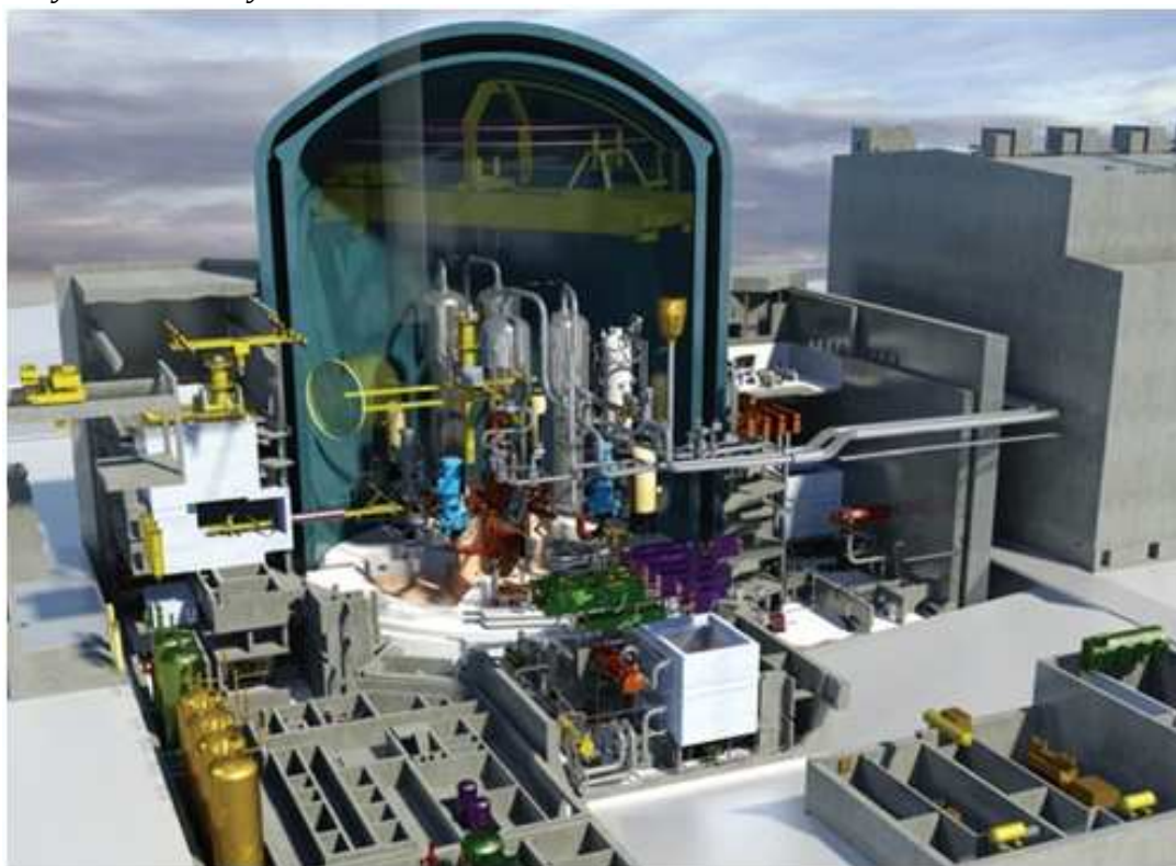
Obr. 2. Řez reaktorovou budovou reaktoru EPR
