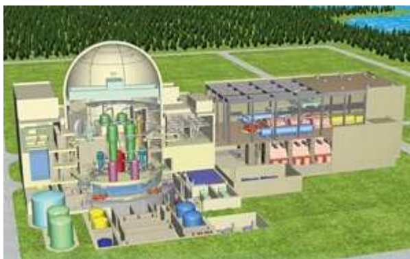
Obr. 4. Celkový pohled na elektrárnu s reaktorem EU-APWR
