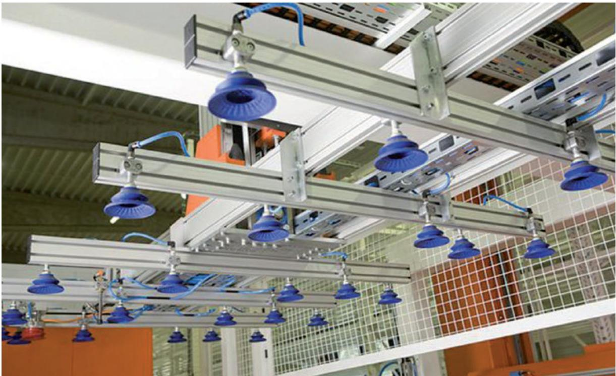
*Abb. 4. Vakuumgreifer des Handlingsgeräts*
