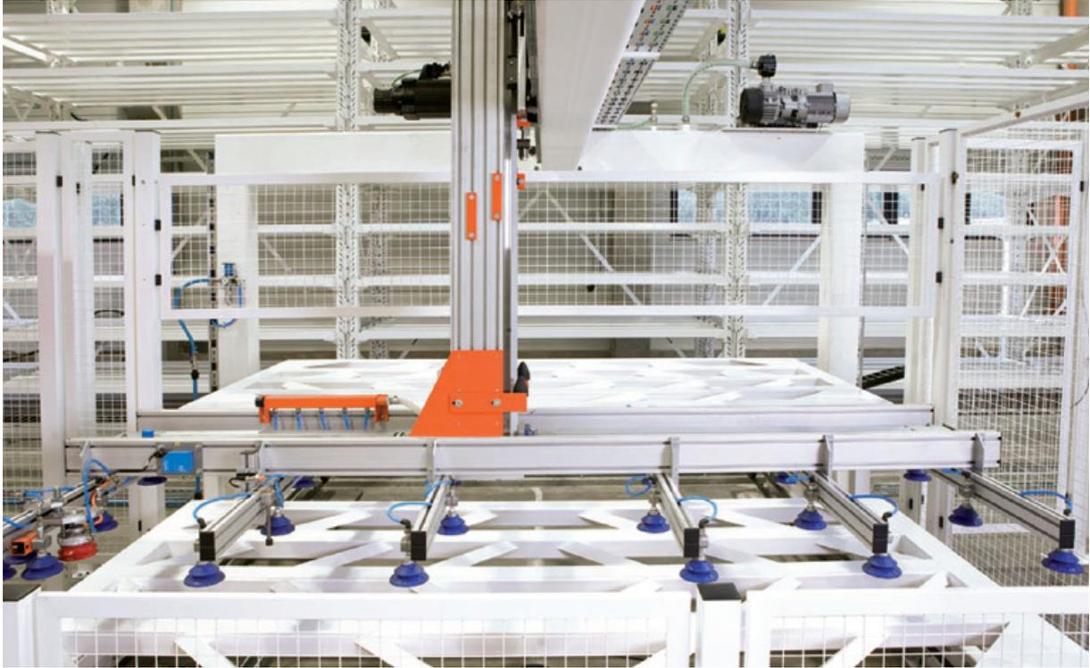
*Abb. 3. Handlingsgerät über dem Verschiebetisch*
