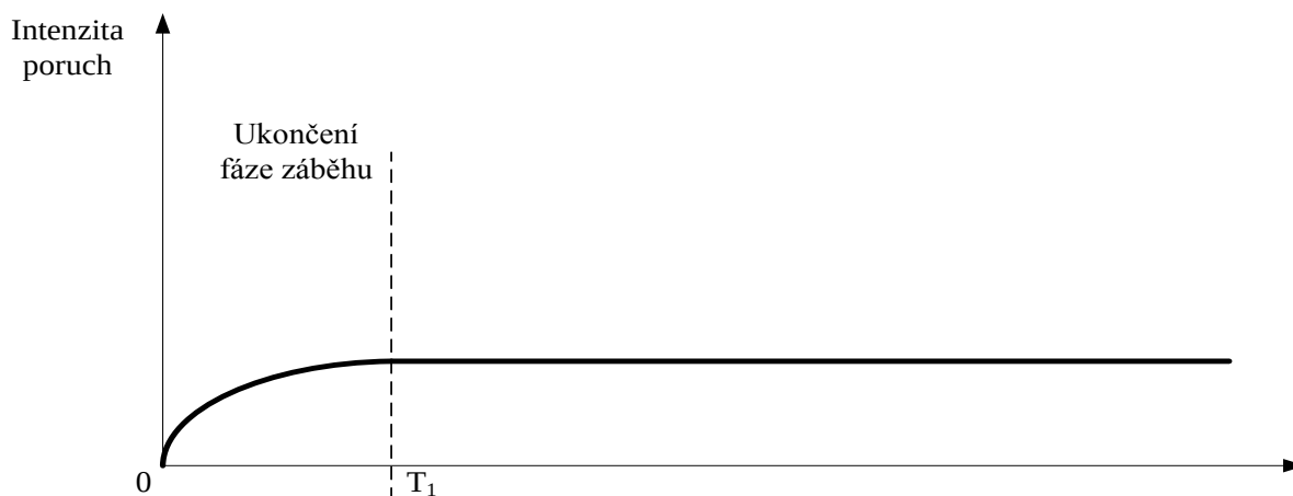
Obrázek 8: Ustálení intenzity poruch po záběhové fázi
