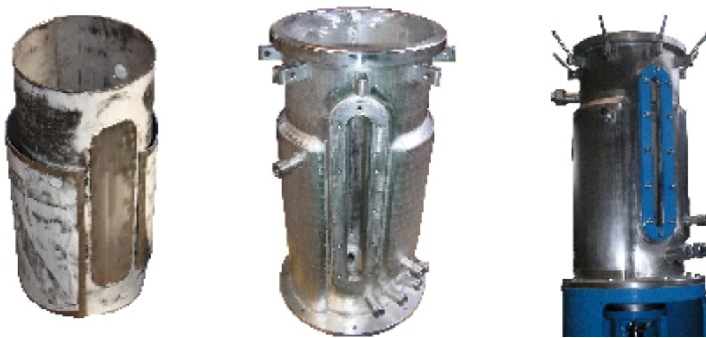
Obr. 11. Konstrukční řešení duplikátorového pláště.
