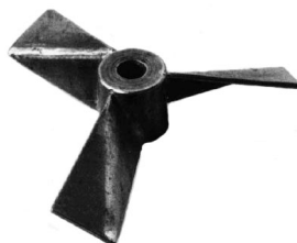
B – míchadlo s rovnými lomenými lopatkami
