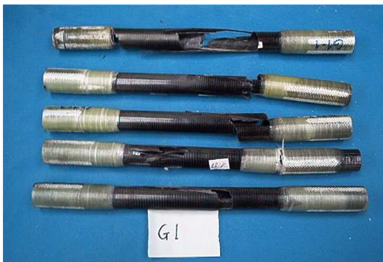
Obr.5.1.2 Detail zkušebních vzorků po poruše
