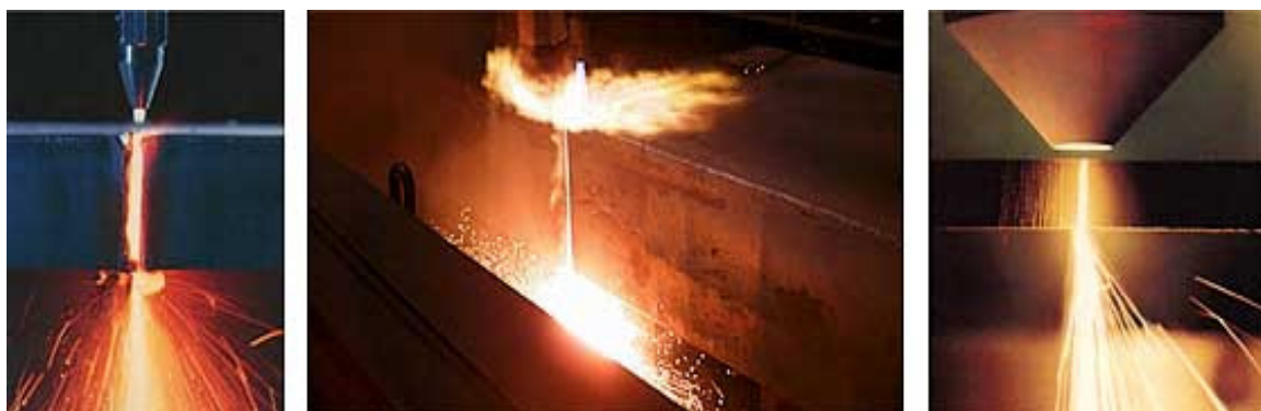
Obr.: 1 Dělení materiálů za pomoci termických technologií
