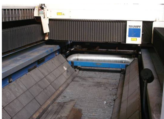
Obr.: 6 Pásový dopravník s kovovými lamelami
