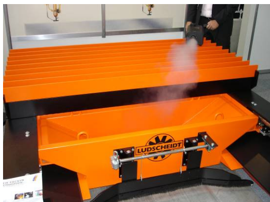
Obr.: 4 Pojezdný sběrný kontejner s integrovaným odsáváním
