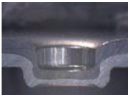
Obrázek 1.5-3 Tvorba pevného spojení materiálů
