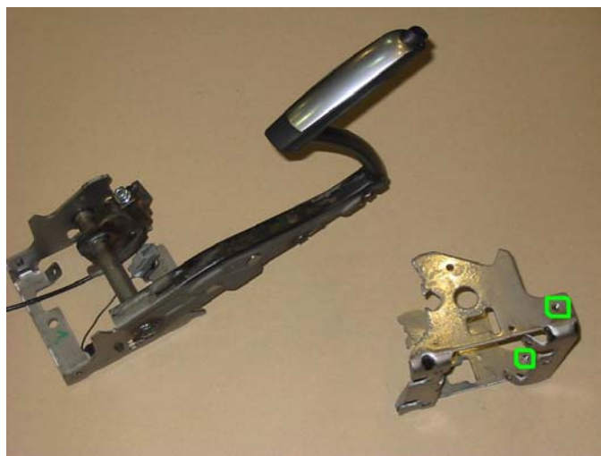
Obrázek 1.5-1 Příklad závitů vytvořených přípravkem PRONIC vpravo, vlevo výsledná sestava
