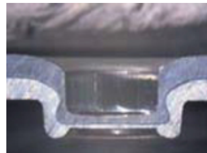
Obrázek 1.5-4 Finální spoj metodou TOX Round Joint
