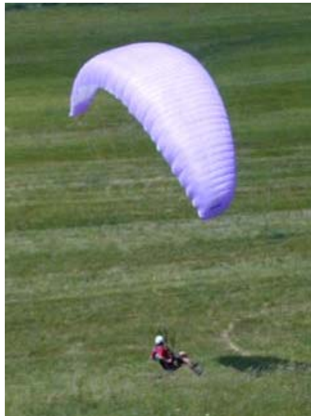
Obr. 1.2-4. Deformace odtokové hrany vlivem zásahu do řízení PK, těsně před přistáním. Kluzák Gradient Avant 26. Foto autor, pilot Petr Mihalov.
