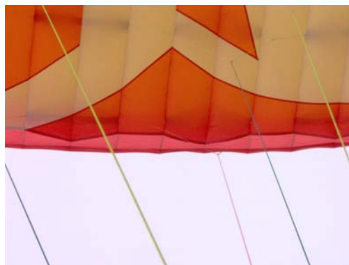
Obr. 1.2-3. Pohled na spodní stranu parakřídla během letu a tvarování plnicích otvorů. Dobře patrná je zde deformace spodního a horního potahu vlivem tlakových poměrů. Kluzák Gradient Orbit 26. Foto autor.
